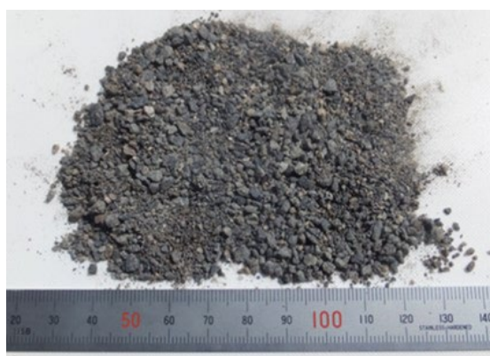
図 4 粒径 5mm の砂※
